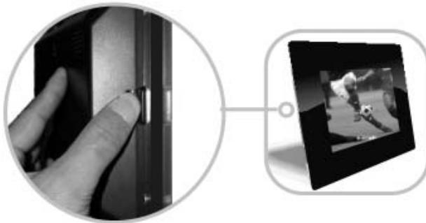
2. Приподнимите фоторамку и осторожно извлеките ее из креплений, расположенных справа на съемной панели .
