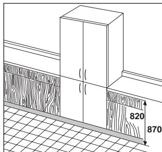
Перед тем, как установить холодильник между мебелью, отрегулируйте высоту задних колес и ножек. Колеса устанавливаются на заводе на высоту 820 мм. Чтобы поднять прибор до высоты 870 мм необходимо вращать специальным ключом ножки, затем отсоединить колеса и закрепить их в самом нижнем положении.
