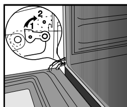
1 Петля дверцы при нормальном использовании
