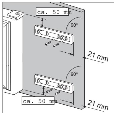
6. Приложите направляющую на внутреннюю сторону двери шкафа, сверху и снизу, как показано на рисунке, и отметьте положение крайних отверстий. Подготовив отверстия, установите направляющую при помощи входящих в комплект винтов.
