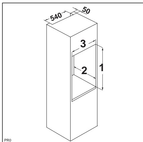
Необходимо, чтобы проем, в который производится встраивание, имел вентиляционное отверстие следующих размеров:
