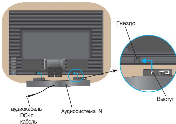
3. После настройки динамика подключите аудиокабель DC-In к задней панели монитора.
