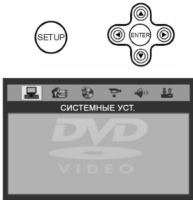
Нажмите кнопку SETUP на пульте дистанционного управления, чтобы отобразить экран установки, используйте кнопки **◀/▶** и ENTER, чтобы выбрать требуемый пункт:
