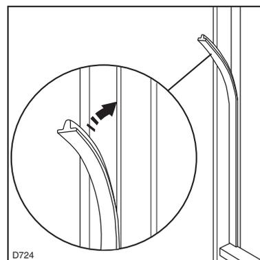
Установите крышки (C-D) в стыки и отверстия под петли. Установите на место вентиляционную решетку (B) и крышку петли (E).
