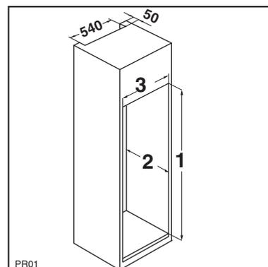
Установите прибор в выемку для встраивания таким образом, чтобы он прилегал к внутренней поверхности кухонного шкафа с той стороны, с которой у него установлены петли дверцы. Вставьте прибор так, чтобы верхняя полоса уперлась в кухонный шкаф (1); убедитесь, что нижняя петля находится на одной линии с поверхностью кухонного шкафа (2).
