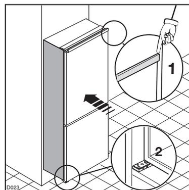
Прикрепите прибор с помощью 4 винтов, входящих в комплект, прилагаемый к холодильнику. (I = короткие) (P = длинные)
