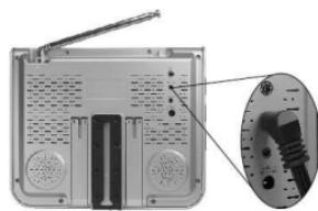
2. Вставьте желтый штекер (видео) шнура аудио/видео в желтый разъем внешнего источника, белый штекер (левый аудио канал) – в белый разъем, красный штекер (правый аудио канал) - в красный разъем. Затем вставьте другой конец шнуря в разъем AV2/IN на задней панели телевизора.
