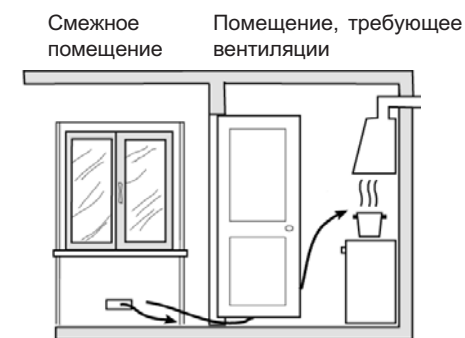
Увеличение зазора между дверью и порогом для свободного прохода приточного воздуха
