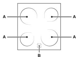
А. Варочная зона со спиральными нагревательными элементами.
