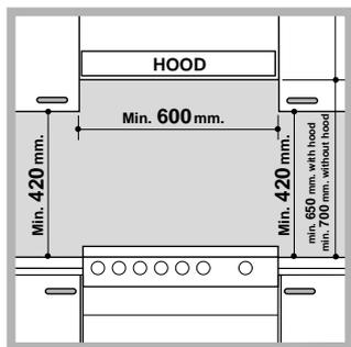
высоте не менее 420 мм от поверхности варочной панели. Это расстояние должно быть 700мм, если навесные шкафы выполнены из возгораемого материала (см. рисунок);
