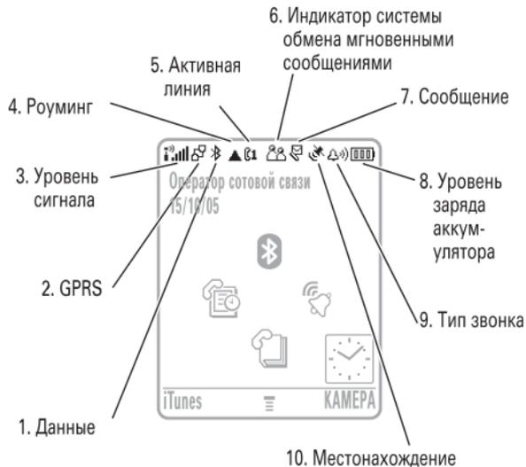
**1 Индикатор данных.** Этот индикатор показывает состояние соединения. Когда телефон подключен к другому устройству, появляется индикатор Bluetooth®
