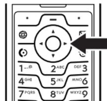
Выделив какой-либо элемент на дисплее, нажмите центральную часть клавиши выбора
