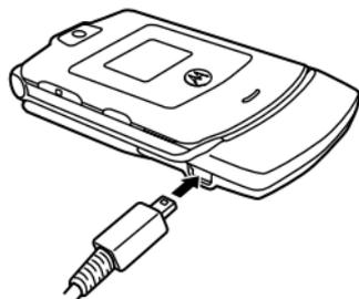
крышку и подключите к телефону портативное зарядное устройство, как показано на рисунке. Вставьте вилку зарядного устройства в электрическую розетку. Прежде чем начнется зарядка аккумулятора, может пройти несколько секунд. Во время зарядки на телефоне горит индикатор зарядки аккумулятора. По завершении зарядки на дисплее появится сообщение **Зарядка окончена**.
