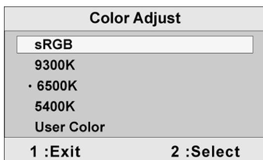
**sRGB**-RGB быстро становится производственным стандартом управления цветом, который поддерживает большинство современных приложений. Эта настройка позволяет более точно отображать цвета на ЖК-дисплее. Включение настройки sRGB делает регулировку контрастности и яркости недоступной.
