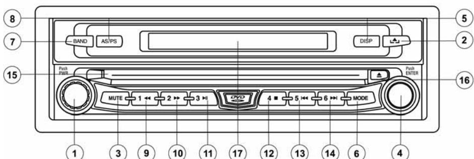
1. Нажимайте на регулятор для включения/выключения питания **PWR**. Регулятор громкости звука. Вращайте по часовой стрелке или против для увеличения и уменьшения громкости звука соответственно.
