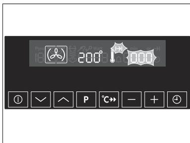
Отключение звукового сигнала: Нажатием любой кнопки.
