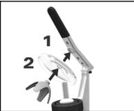
Установите рукоятку (**A**) в верхнее положение. На рукоятку установите крышку (**C**), при правильном закрытии она должна щелкнуть. Вращательным движением слева направо замкните держатель для цитрусовых (**D**).
