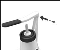
Ось закрепления (**B**) установите в предназначенное для этого отверстие. Ручка-рычаг может вращаться над корпусом прибора.
