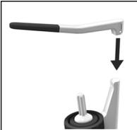
На корпус прибора (**K**) установите ручку-рычаг (**A**), при этом держите её в горизонтальном положении.
