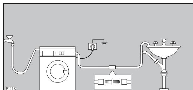
**Для обеспечения правильной работы машины сливной шланг должен быть всегда подведен за соответствующий кронштейн, расположенный в верхней части задней панели машины.**
