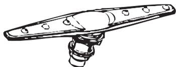
Подвижные форсунки необходимо чистить регулярно, иначе накипь и отложения жесткой воды засорят форсунки и каналы для воды. Для этого открутите гайку, снимите верхнюю часть подвижного механизма и затем снимите форсунку. Вымойте форсунки в теплой мыльной воде и используйте мягкую щетку для чистки отверстий. После промывки установите их обратно.
