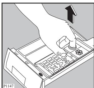
Стиральный порошок может также скапливаться в проеме для дозатора: прочищайте его с помощью старой зубной щетки. После чистки установите дозатор на место.
