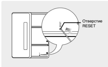
Если плеер начнет работать неправильно, вы можете установить его систему в исходное состояние нажатием в отверстие RESET (Сброс).
