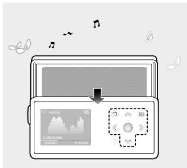
Во время прослушивания музыки или радиопередачи сдвиньте сдвигающуюся панель плеера в середине в направлении, указанном стрелкой.
