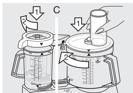
стрелке, направляя ее носик в отверстие запора моторного блока  $\textcircled{1}$  до тех пор, пока не будет слышен звук защелки.
