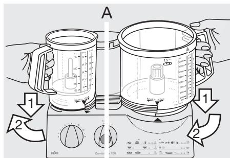
Затем следует повернуть емкость в направлении вращения до тех пор, пока будет достигнуто нижнее фиксированное положение. На другом приводном месте емкость должна находиться в поднятом положении. В том случае, когда другое приводное место свободно, следует установить на него защитный кожух  $\textcircled{13}$ .
