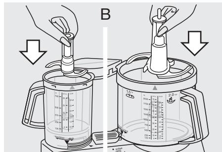
дого приспособления) на приводной вал емкости и нажмите на него вниз до тех пор, пока оно не достигнет крайнего нижнего положения (B). Когда Вы вставляете нож I в малую емкость  $\textcircled{10}$ , нажмите ее вниз таким образом, чтобы Вы услышали щелчок.
