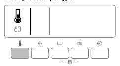
Нажимайте последовательно кнопку "Температура" ▋, чтобы повысить или понизить температуру случае, если необходимо стирать при отличной от той, температуре, которая была выбрана стиральной стирке в холодной воде.
