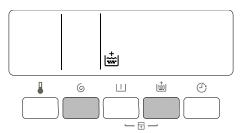
Нажимайте в течение нескольких секунд кнопки "Отжим" © и "Полоскание плюс" . Функция окажется включенной постоянно, даже при отключении прибора от электросети.
