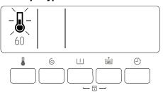
В процессе выполнения цикла происходит изменение символа в при нагревании прибора.
