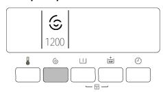
Нажимайте последовательно кнопку "Отжим" 6, чтобы повысить или понизить скорость отжима в случае, если необходимо выполнить МИЖТО белья скорости, отличной от той, которая была выбрана стиральной машиной. Можно также выбрать один из следующих вариантов: "Без отжима" <u>⑤</u>, "Остановка с водой в баке" <u>□</u>\* или "Ночной режим плюс" <u>(\*</u> (\*).
