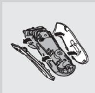
**3** Отвинтите два винта на задней панели электробритвы и снимите заднюю панель.
