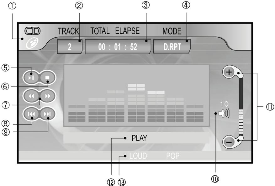
В режиме работы CD проигрывателя прикоснитесь к экрану монитора для вывода на экран меню для управления функциями CD проигрывателя.
