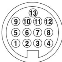
Для подсоединения навигационной системы, которую поддерживает данный аппарат, используйте 13-контактный кабель. При включении аппарата навигационная система будет определена автоматически.
