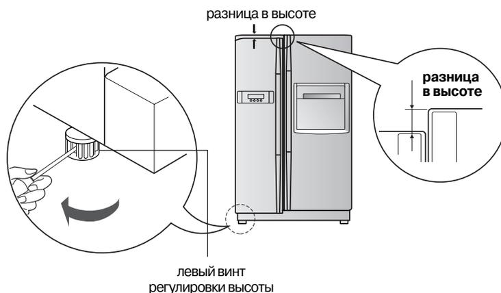
Для выравнивания дверец вставьте отвертку в желобок правого винта регулировки высоты и поверните его по часовой стрелке (↻).
