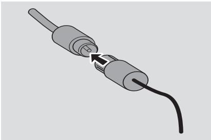
**Примечание:** Если вы используете кабельную antennу системы или внешнюю antennу, то их следует подсоединить в гнездо FM ANTENNA вместо проволочной antennы.
