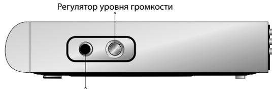
Гнездо для подключения микрофона
