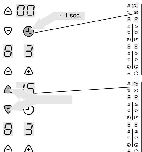
показываемое время относится к конфорке с самым малым остающимся временем. Контрольные лампы прочих конфорок с задействованной отключающей автоматикой горят. Чтобы посмотреть остающееся время одной из этих конфорок, надо выбрать эту конфорку с помощью сенсорного поля таймера  $\odot$ . При этом соответствующая контрольная лампа мигает быстро.
