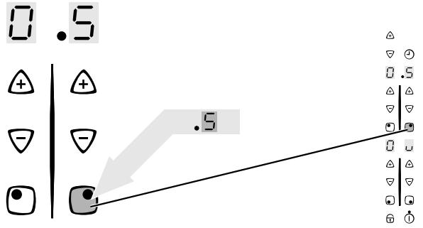
3. Для выключения наружного нагревательного контура прикоснуться к сенсорному полю "Овальная конфорка"
