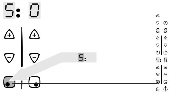
4. Для выключения наружного нагревательного контура прикоснуться к сенсорному полю "Трехконтурная конфорка"
