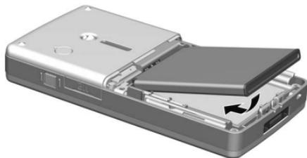
Чтобы открыть крышку отсека аккумуляторной батареи, необходимо слегка надавить на ее верхнюю часть и сдвинуть вниз. Вставьте аккумуляторную батарею и установите на место крышку.
