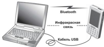
Для синхронизации подключите телефон к компьютеру через USB-соединение, Bluetooth или ИК-порт.
