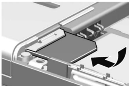
Извлеките батарею (если она установлена) и установите SIM-карту в держатель SIM-карты. При первом включении телефона необходимо ввести PIN-код, выданный вместе с SIM-картой.
