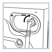
2. Подсоедините заливной шланг к стиральной машине, навинтив его на водоприемник, расположенный в задней верхней части справа (см. рис.).
