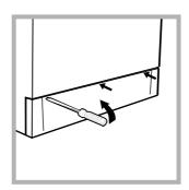
1. снимите переднюю панель стиральной машины при помощи отвертки (см. puc.);
