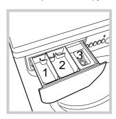
Выдвиньте распределитель и заполните его отделения моющим средством и смягчителем:
