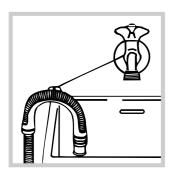
Повесьте загнутый конец сливного шланга на край раковины, ванны, ипи поместите специальный вывод канализации. Шланг не должен перегибаться. Верхняя точка сливного шланга должна находиться на высоте 65-100 см от пола. Расположение сливного шланга должно обеспечивать разрыв струи при сливе (конец шланга не должен быть опущен в воду).
