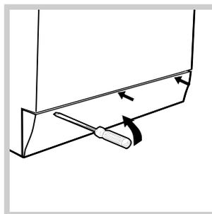
3. снимите нижний плинтус стиральной машины (при помощи отвертки (см. *рисунк*)).
