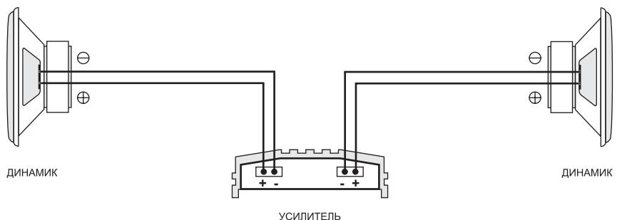
B) Схема подключения компонентных динамиков.
