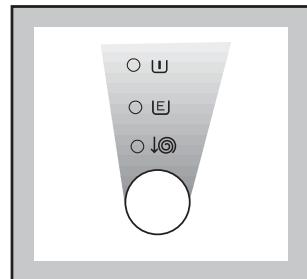
Нажмите кнопку ДОПОЛНИТЕЛЬНЫХ ФУНКЦИЙ, чтобы загорелась одна лампа.
