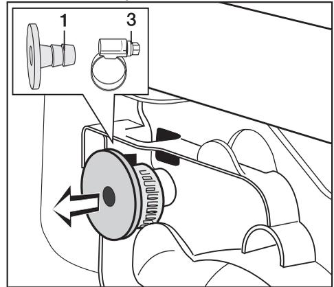
щиеся в верхней части обратной стороны сушильной машины: адаптер (насадку) **1** и лежащий за ним хомут шланга **3**.
