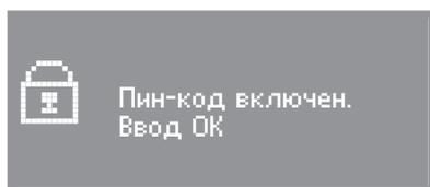
После выключения сушильной машины ею можно будет пользоваться только после ввода кода.
