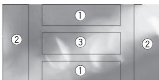
– Границы не могут отображаться на экране. Этот пример призван показать, где необходимо касаться сенсорной панели при работе с ней.
