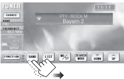
Данный приемник работает на трех диапазонах FM (FM1, FM2, FM3). Для прослушивания радиовещания на частотах FM можно использовать любой из них.
