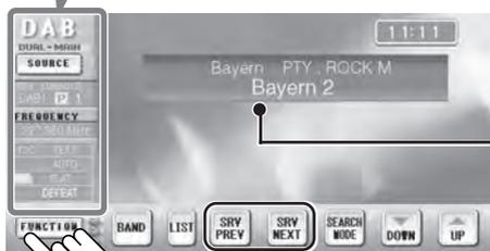
Обозначение блока трансляции или код PTY, обозначение службы.
