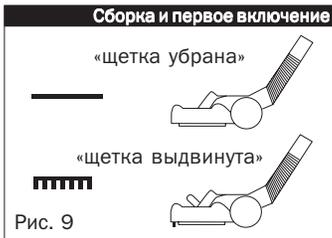
Это очень эффективный и надежный инструмент, который может быть использован на всех типах полов. Щетка имеет два положения. В положении «щетка убрана» эта насадка используется для чистки ковров, обивки мягкой мебели (кровать, диваны и пр.) и матрасов. В положении «щетка выдвинута» эта насадка используется для уборки полов (рис. 9).
