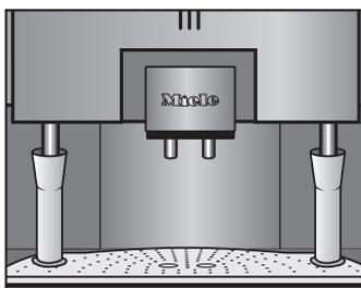
поставьте воронки в отверстия в ситечке так, чтобы жидкость из насадок направлялась с помощью воронок в поддон.
