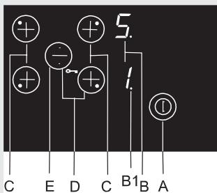
Если Вы включили варочную панель с помощью сенсора включения/выключения (A), в течение следующих 10 секунд Вы можете включить выбранную конфорку (зону нагрева).
