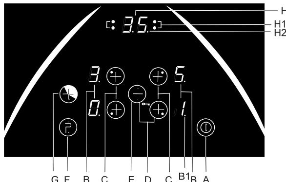
**A** Сенсор включения/выключения варочной панели
