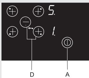
Активированная функция блокировки позволяет Вам предотвратить работу или использование конфорок. Таким образом, функция блокировки может быть использована и в качестве защиты от детей.
