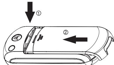
Чтобы избежать повреждения крышки батарейного отсека, устанавливайте ее только так, как описано в данной инструкции.
