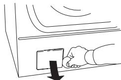
3. Слейте воду, например, в таз, отсоединив шланг насоса от патрубка внутри люка.
