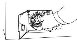
6. Навинтите крышку с фильтром, снова наденьте сливной шланг на патрубок в люке и закройте крышку люка.
