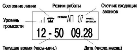
Рис. 1. Индикация на дисплее в основном состоянии
