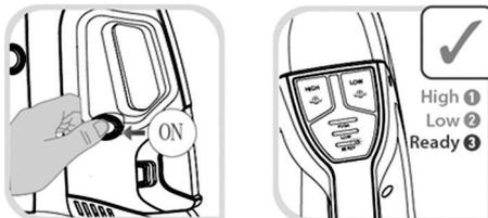
На рукоятке передвиньте блокиратор вниз, при этом нажимая на курок подачи пара, и начинайте уборку. Чтобы выключить паровую швабру нажмите на кнопку включения паровой швабры.
