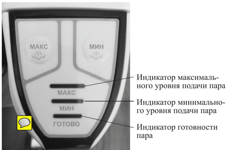
**Индикатор готовности пара** загорается и мигает, когда паровая швабра включена **кнопкой включения паровой швабры**. Также загорится **индикатор максимального уровня подачи пара**. Когда пар будет готов, индикатор готовности пара перестанет мигать и будет гореть непрерывно.
