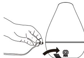
6. Нажмите кнопку «Вкл/Выкл», установите желаемую интенсивность тумана. При первом нажатии на кнопку включается максимальная интенсивность тумана, второе нажатие включает минимальную интенсивность тумана, третье нажатие выключает увлажнитель. Чем больше тумана, тем интенсивнее увлажнение воздуха.
