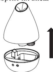
3. Откройте крышку резервуара против часовой стрелки, залейте чистую холодную воду в отверстие резервуара. Закрутите крышку резервуара по часовой стрелке, переверните резервуар для воды и установите его обратно на основание увлажнителя.
