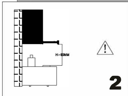
Мы рекомендуем, чтобы после установки низ вытяжки располагался на высоте не менее 650 мм и не более 750 мм над нагревательными элементами и горелками плиты.
