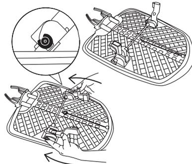
5. Установите доску на телескопические направляющие и заблокируйте фиксаторы.
