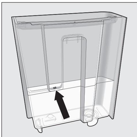
■ Наполните ёмкость для воды до отметки
