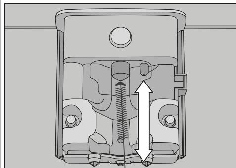
Протолкните щёточку для очистки в паровую форсунку максимум на 1 см.
