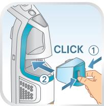
**PL** Filtr przeciwdziałający powstawaniu kamienia kotłowego (znajdujący się za zbiornikiem wody) należy wymieniać raz na 3 miesiące. Przestrzeganie 3-miesięcznego okresu wymiany filtra jest ważne, aby urządzenie długo i bezproblemowo służyło.
