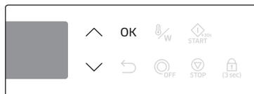
2. Установите температуру с помощью кнопок  $\wedge$  /  $\vee$ , после чего нажмите кнопку **OK**, чтобы перейти к настройке времени.
