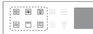
На панели функций выберите **ручной режим**, например режим **Convection** (Конвекция). На дисплее замигает значение температуры (или уровня мощности), заданное по умолчанию.
