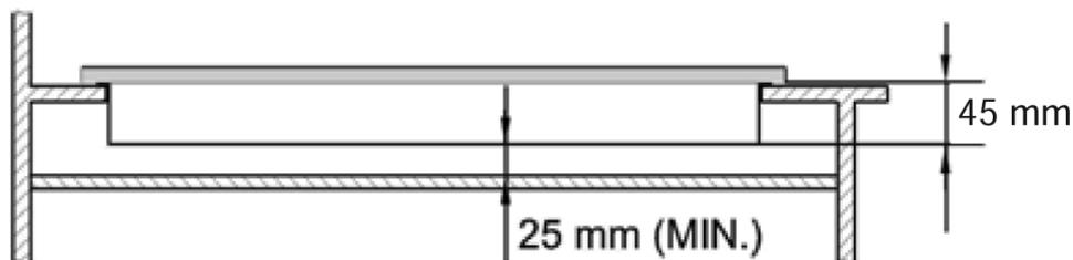
– Варочная панель может быть установлена над духовым шкафом, только если он оснащен системой принудительной вентиляции.
