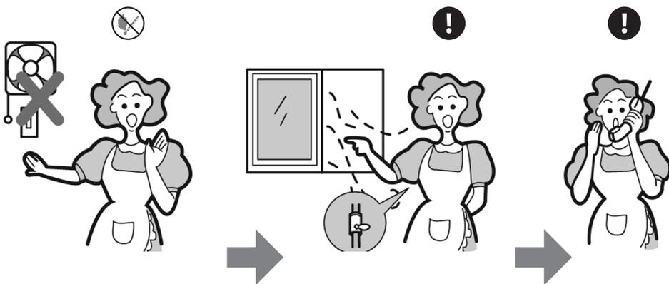
\* В состав горючего газа входит меркаптан, благодаря которому вы сможете по запаху узнать о наличии утечки, даже если содержание этого газа в воздухе составляет всего 1/1000 (ощущается запах гнилого чеснока или протухших яиц).
