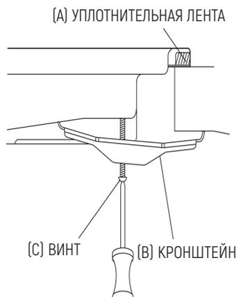
1. Поместите кронштейн (B) над отверстиями, которые соответствуют размеру винтов. В каждом углу варочной панели (H) имеется по одной группе отверстий для винтов. Слегка затяните винтом (C) кронштейн (B), так чтобы кронштейн прижался к корпусу варочной панели, но при этом еще имелась возможность регулировки его положения.
