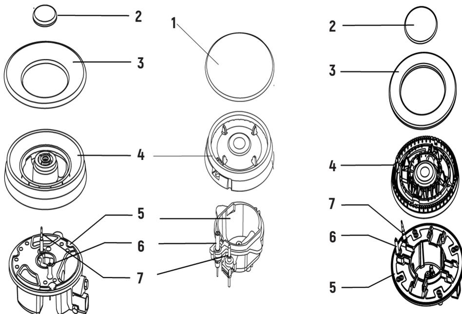
1. Поместите рассекатель (4) на чашу конфорки (5) таким образом, чтобы устройство розжига и устройство контроля наличия пламени прошли через соответствующие отверстия рассекателя. Рассекатель пламени должен быть правильно уставлен.
