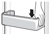
**2** После установки лотка в дверце зафиксируйте его в горизонтальном положении аккуратным постукиванием.
