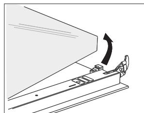
**2** Возьмите стекло дверцы за нижний край, немного приподнимите, чтобы оно освободилось из фиксаторов, и снимите.
