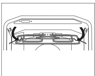
После очистки задвиньте верхние нагревательные элементы обратно, пока держатель не зафиксируется в углублениях.
