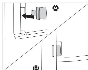
При установке полностью выдвигающихся телескопических направляющих с вкладышами EasyClean установите фиксаторы (прилагаются в комплекте) в отверстия в нижней части боковых стенок духовки. Защелкните направляющие в фиксаторах. Фиксаторы обеспечивают более прочную установку направляющих.
