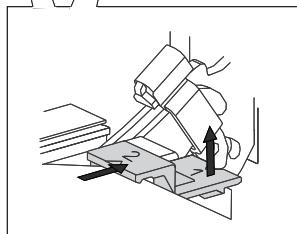
**1** Немного приподнимите фиксаторы с левой и правой стороны дверцы (символ 1 на фиксаторе) и потяните в стороны от стекла (символ 2 на фиксаторе).
