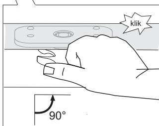
Пальцем отодвиньте замок вправо на 90° до щелчка. Замок дверцы заблокирован (в нерабочем состоянии).
