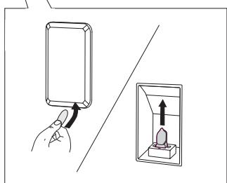
С помощью отвертки подденьте и снимите крышку. Замените лампочку.
